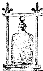
Фиг. 3. Герметически-запирающаяся стеклянка для различныхъ реакцій при нагреваніи.
